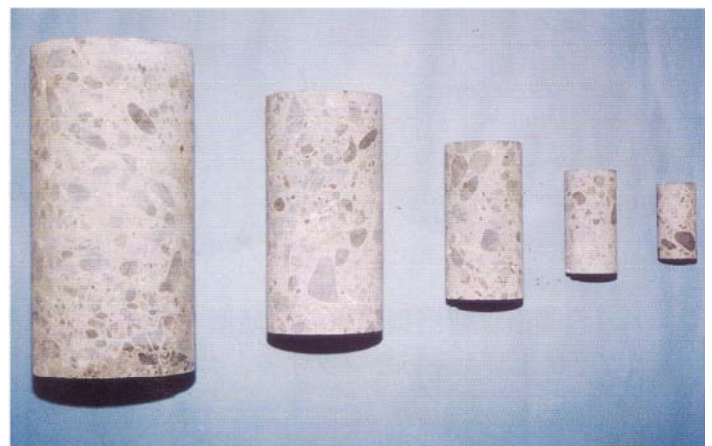
写真-2 コア供試体の形状 (左から \phi 100\text{mm} , 75mm, 50mm, 33mm, 25mm)
